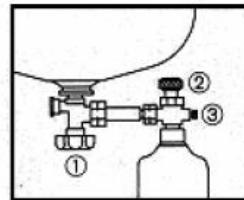
Bei Austritt flüssigen Propans aus der Entlüftung, Ventile in umgekehrter Reihenfolge schließen:
