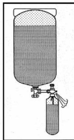
Flaschendrehgestell umdrehen. Flasche wird volumetrisch gefüllt
