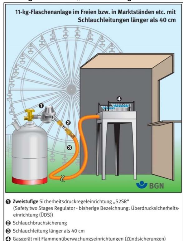
Bild 1 Beispielhafte Flüssiggasanlage
