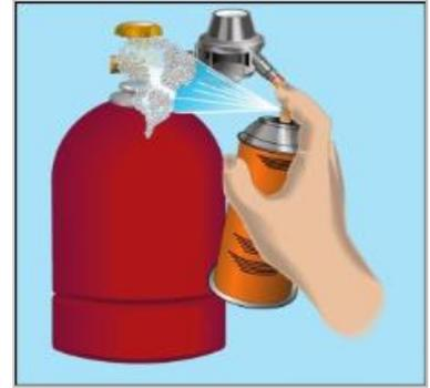
*Bild 5 Dichtheitsprüfung der Anschlussverbindung*
