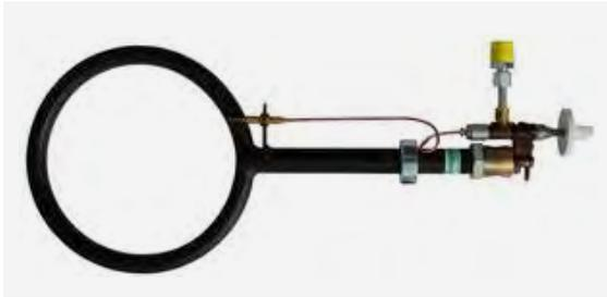
Abbildung 16: Erdgas-Heizelement einer Anschlagmaschine
