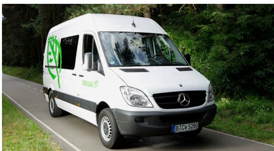
Abbildung 28: Transporter mit Erdgas-Antrieb
