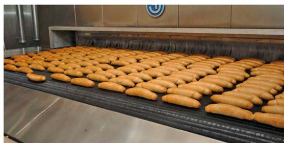
Abbildung 13: Ausgangsseite eines Tunnelbackofens
