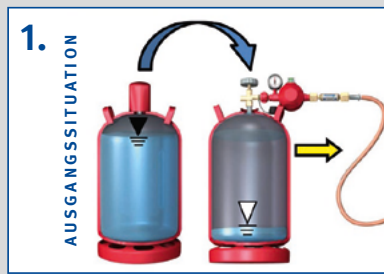
1. AUSGANGSSITUATION Die entleerte Flasche soll gegen eine volle ausgetauscht werden
