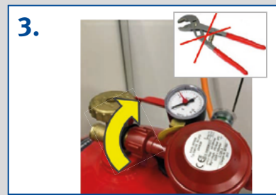
3. Jetzt mit der Hand Druckreguleinrichtung abschrauben – rechtsherum drehen, keine Zange benutzen
