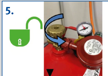
5. Flasche aufdrehen – dazu Rad linksherum drehen
