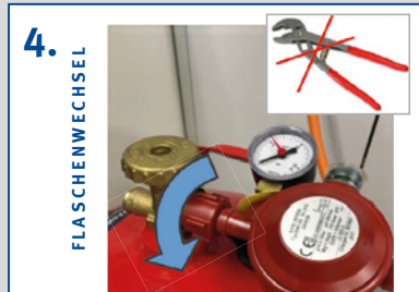
4. FLASCHENWECHSEL Druckreguleinrichtung mit der Hand festschrauben – linksherum drehen, keine Zange benutzen
